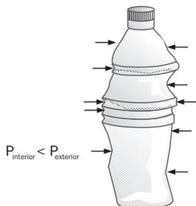
Al calentar suavemente un recipiente deformable (por ejemplo, de plástico) parte del aire contenido en él es expulsado. Si se cierra el recipiente y se deja enfriar, podremos comprobar que este se aplasta, debido a que la presión ejercida por el aire en el interior es menor que en el exterior (al escaparse parte de la masa de aire y alcanzar la temperatura exterior, el número de choques, por unidad de superficie, disminuye).
